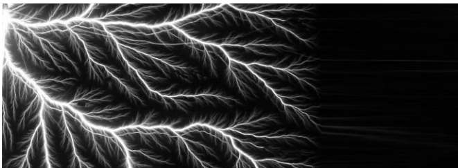
Ausbildung eines leitfähigen Pfades (electrical treeing) auf oder in Isolationsmaterialien
